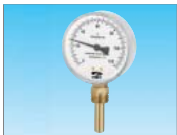
Cassa: in acciaio cromato Trasparente: in plastica Gambo: radiale in ottone Elemento termometrico: spirale bimetallica Guaina: in ottone, 1/2 Grado di protezione: IP31
