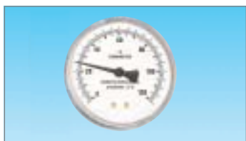
Cassa: in acciaio zincato. Trasparente: in plastica. Gambo: posteriore centrale in acciaio zincato. Precisione: Cl.2 Elemento termometrico: spirale bimetallica Guaina: in ottone Grado di protezione: IP31
