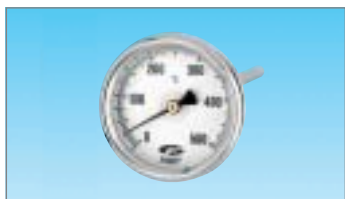
Cassa: in acciaio zincato Anello: in acciaio cromato Trasparente: in vetro Elemento termometrico: spirale bimetallica. Gambo: posteriore centrale in acciaio zincato senza guaina
